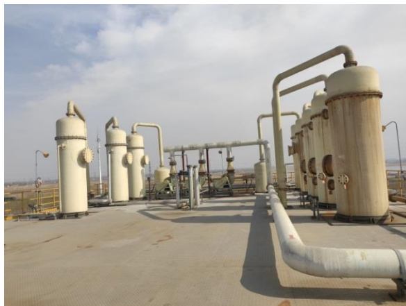
图 4-3 氯甲酸氯甲酯尾气处理系统
